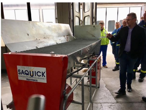
Die Füllmaschine verfügt über zwei Motoren: Einer treibt die Förderschnecke an, die den Sand in den Einfüllstutzen transportiert, der andere Motor bewegt den sogenannten Rüttler. Dieser sorgt durch rüttelnde Bewegung dafür, dass der Sand nachrutschen kann. Ferner ist vor Ort eine spezielle Nähmaschine für das Verschließen der Sandsäcke vorhanden.
