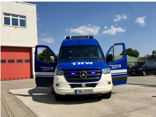
Der neue MTW ist knapp 6m lang, 2,8m hoch, 2,3m breit und hat 142 PS. Anstelle von sechs Sitzmöglichkeiten im hinteren Bereich verfügt das Fahrzeug über vier Sessel. Der versenkbare Tisch ist dafür deutlich größer ausgefallen und bietet nun die Möglichkeit, Lagekarten und Informationen unter einem transparenten Plexiglas einzuschieben.
