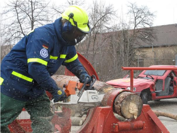
Um einen sicheren Umgang mit der Motorkettensäge zu bekommen, werden verschiedene Übungen und Ausbildungen durchgeführt. So ist die Übung am Spannungssimulator auch ein Teil der Ausbildung zum Motorketten-Sägenführer. An diesem Gerät wird ein Baumstamm durch hydraulischen Druck unter Spannung gesetzt, um so Sturmholz zu simulieren. Durch verschiedene Sägetechniken wird dem Stamm der Druck genommen und kann dann
